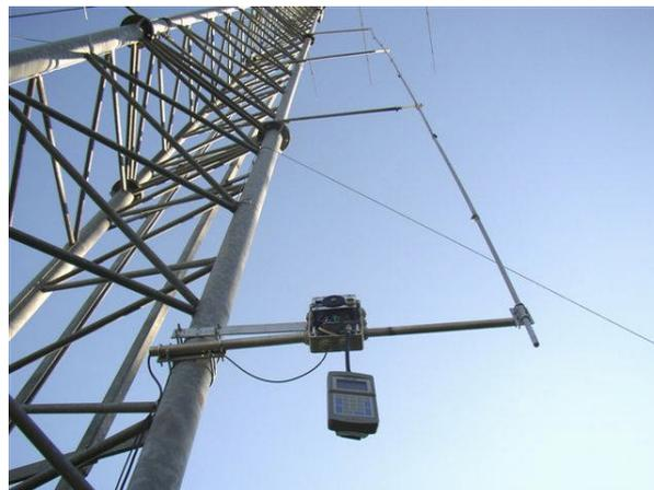
In questo modo ero riuscito a far scomparire elettricamente l’ingombrante traliccio ed eliminare le interferenze con la Flag in ricezione. Quindi potevo tentare di migliorarla ulteriormente trasformandola in una loop a due elementi, ottimizzata al computer, ma che nella realtà non dava i risultati previsti.
